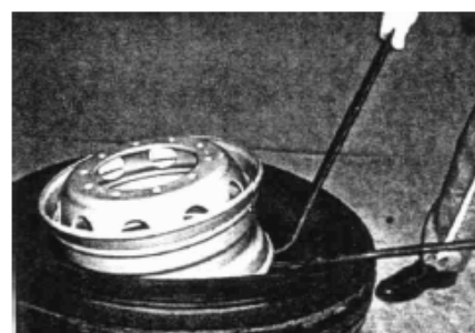
Демонтаж второго борта
