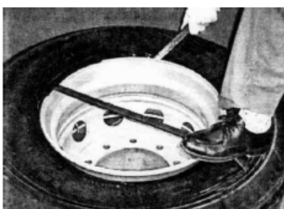
Демонтаж первого борта шины
