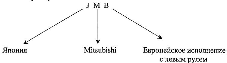
Структура и содержание VIN определены международным стандартом ISO 3779-1983. Стандарт распространяется на автомобили, прицепы, мотоциклы и мопеды. VIN состоит из 17 знаков. За исключением последних четырех позиций, VIN имеет алфавитно-цифровую структуру. Используются только следующие цифры и буквы:
